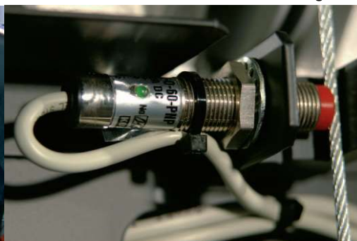
Seilbruch und Schlaffseilerkennung
