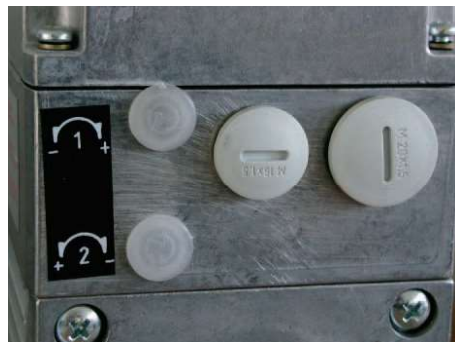
Einstellschrauben der End- und Notendschalter
